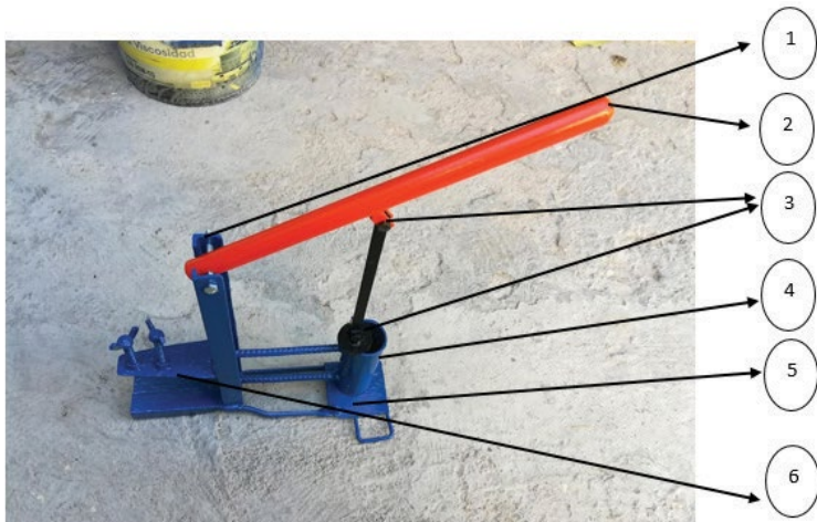
Figura 7. Prensa para elaborar las briquetas Fuente: Elaboración propia
