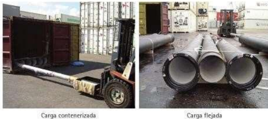
Figura 1.1. Descarga de tubos sueltos, sin embalar, de un contenedor marítimo (izquierda) y unitización de la carga mediante el atado de los tubos con flejes de poliéster (derecha).
